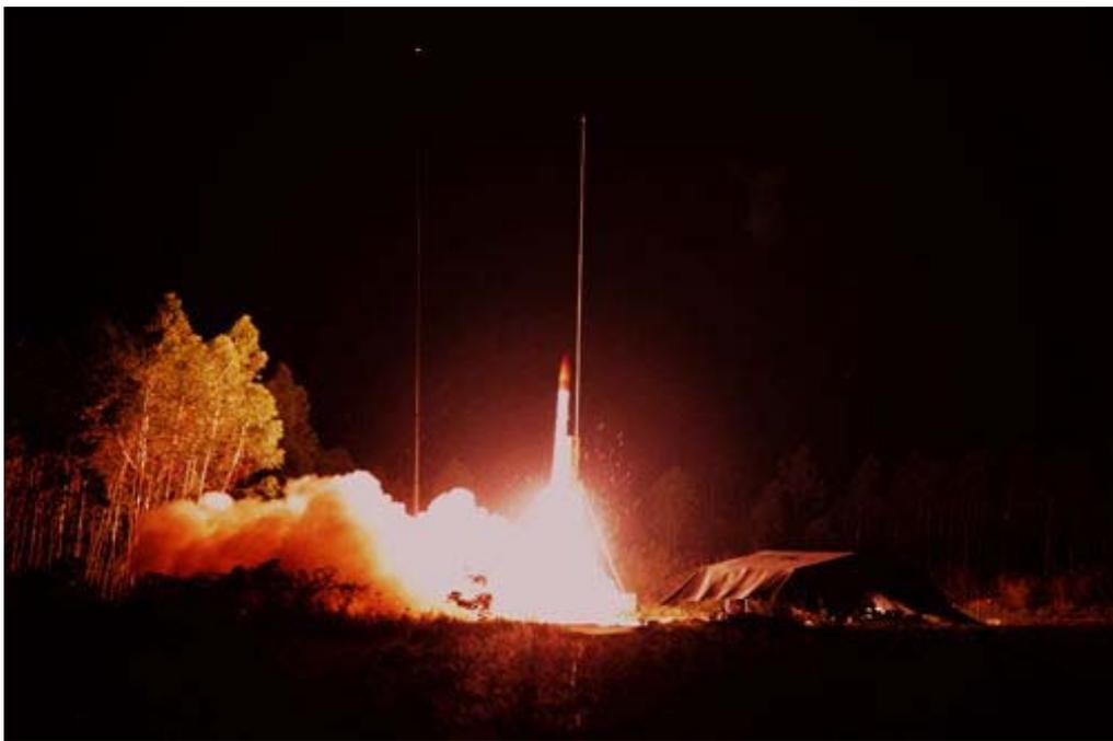
2013年4月5日凌晨5点55分，我国空间环境垂直探测及首次空间科学主动实验在位于海南省儋州市的中科院海南探空部取得圆满成功。这一实验的成功将为研究空间环境主要物理参数在不同高度上的垂直分布提供原位探测数据，对低纬度空间环境垂直分布特征开展研究，为地基遥感观测设备进行标定。同时，探空火箭在200公里高度附近的电离层中释放了金属钡粉，形成了钡云，通过对钡云演化的观测，可以研究近赤道区电离层的动力学特性。这一实验也是我国首次开展的空间科学主动实验。
