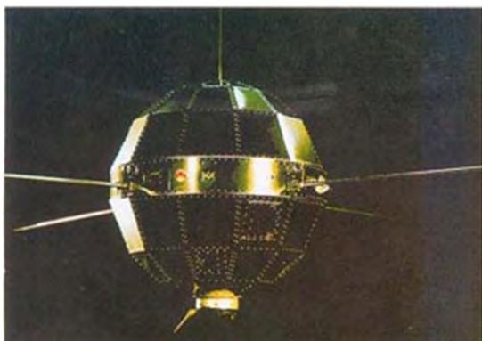
“东方红一号”（Dong Fang Hong I / The East is Red 1）卫星是我国发射的第一颗人造卫星，由以钱学森为首任院长的中国空间技术研究院研制。卫星的主要任务是向太空播放《东方红》乐曲，同时进行卫星技术试验，探测电离层和大气密度。“东方红一号”卫星的发射成功使中国成为世界上继苏联、美国、法国和日本之后第五个完全依靠自己的力量成功发射人造卫星的国家，从此中国正式加入了“太空俱乐部”时代。
